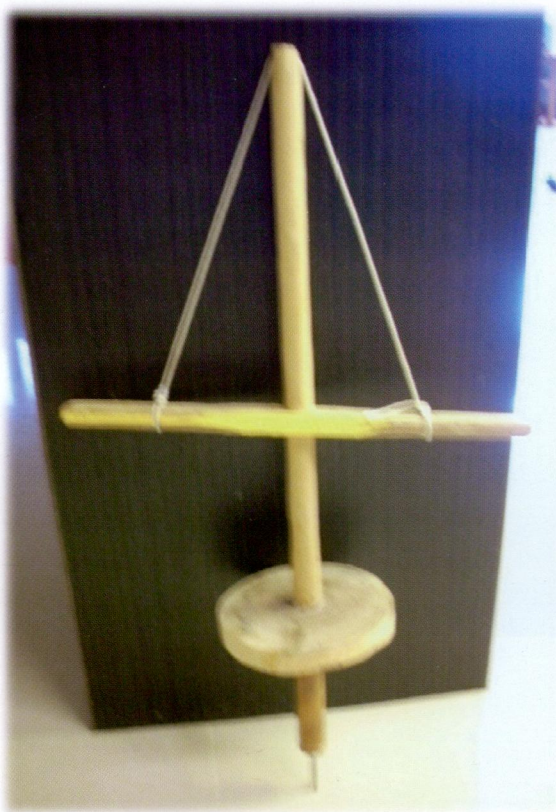
圖 17 在刺球竹竿鑽上小洞的器具
